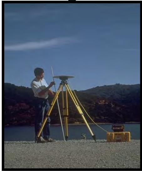
← Base e Rover RTK com precisão centimétrica
